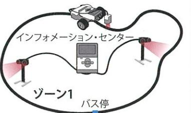
高度交通管制システムのモデル化とシミュレーションセンターが受信した情報を車両モデルに送信して制御
